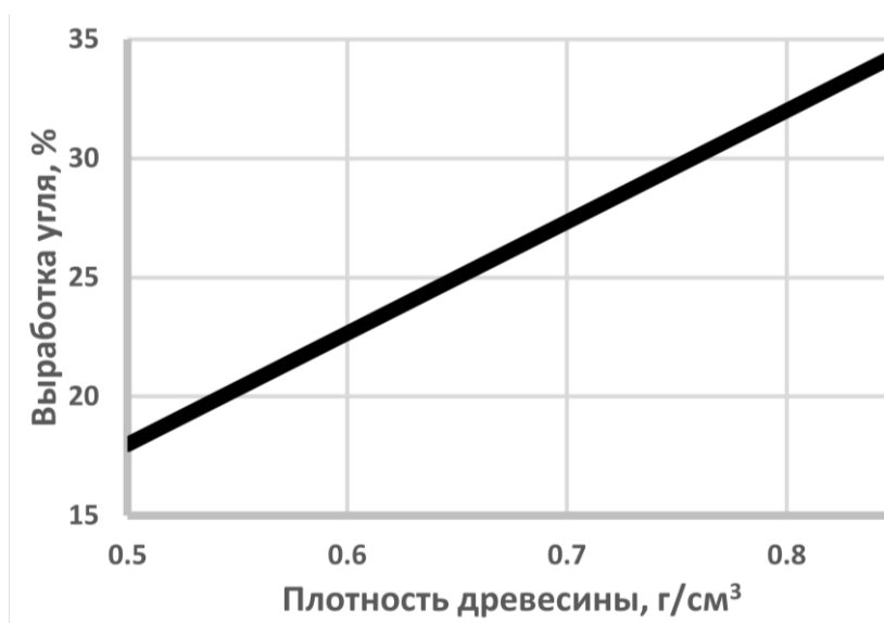
Рис. 6. Зависимость выработки древесного угля от плотности исходной древесины.
