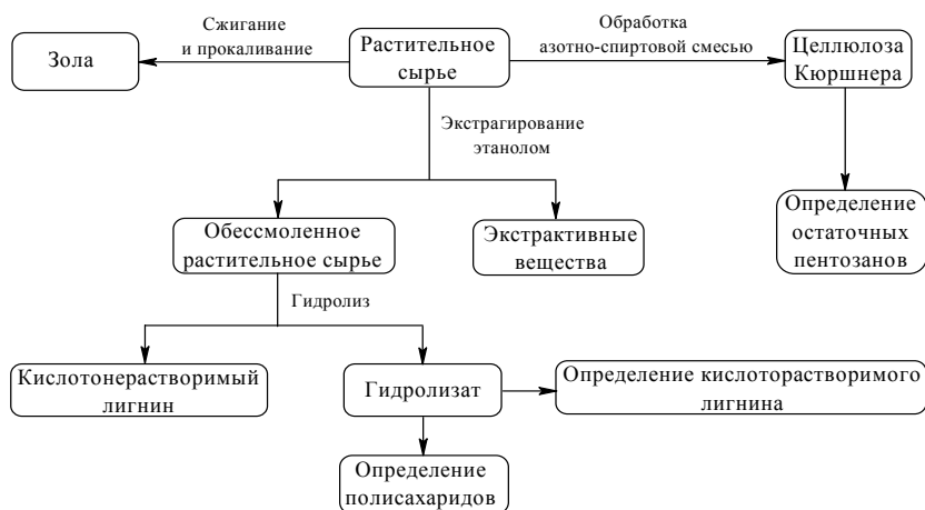
Рис. 3. Схема определения основных компонентов растительного сырья Fig. 3. Scheme of determination of the main components of vegetable raw materials
