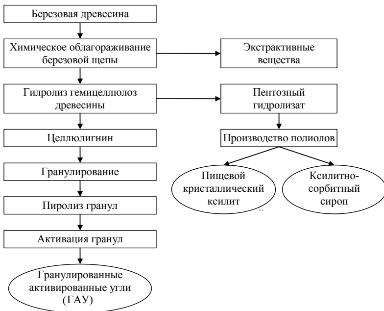
Рис. 1. Принципиальная схема комплексной переработки березовой древесины
