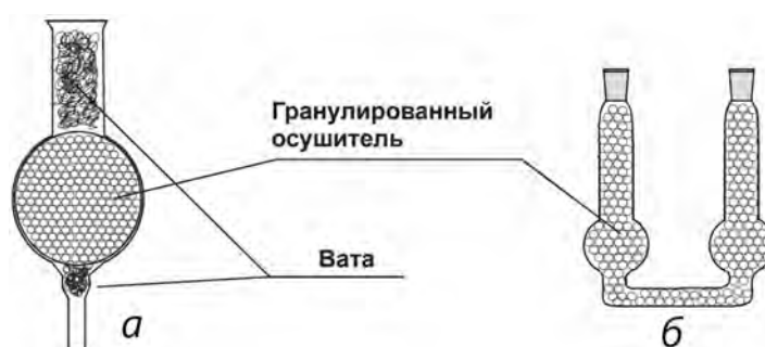
Рисунок 11. Осушительные трубки: а – хлоркальциевая трубка с одним шаром; б – U-образная трубка (обычно используется для осушки потока газа).
