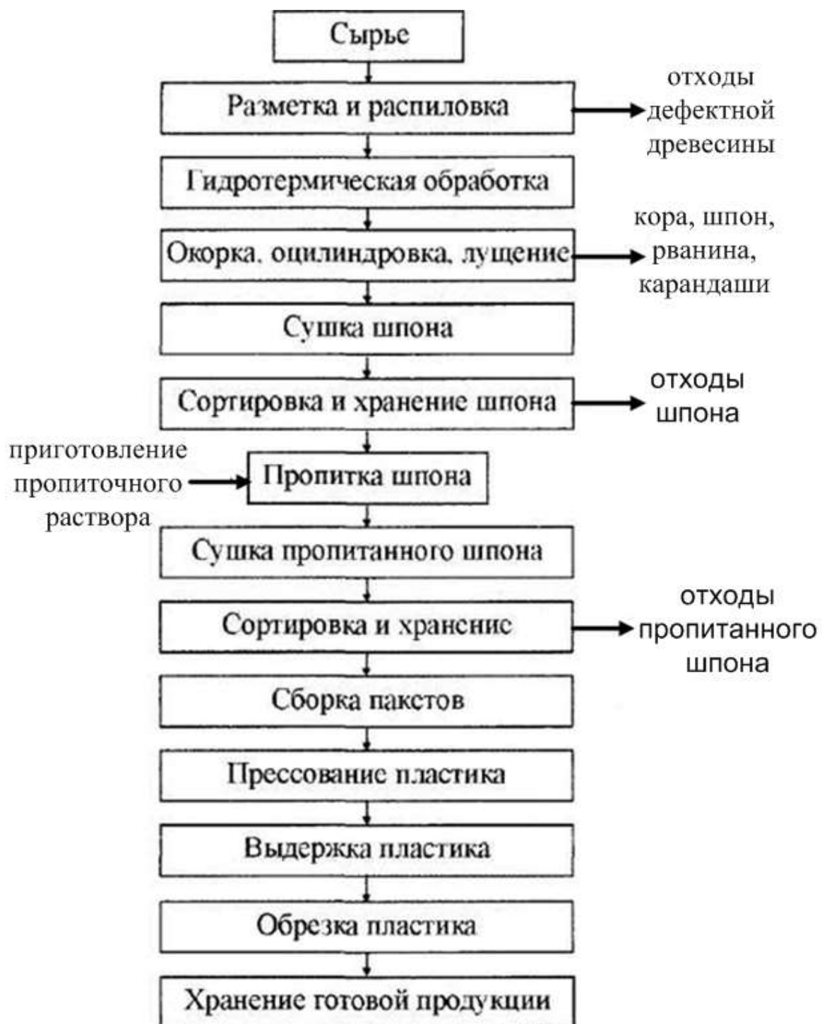
Рис. 2.2. Технологический процесс производства древесностружечных плит с производством шпона
