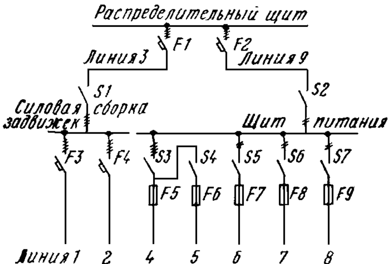
Рис.4.1. Принципиальная электрическая схема питания
