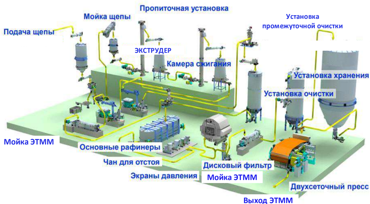
Рис. 1. Технологическая схема производства ЭТММ
