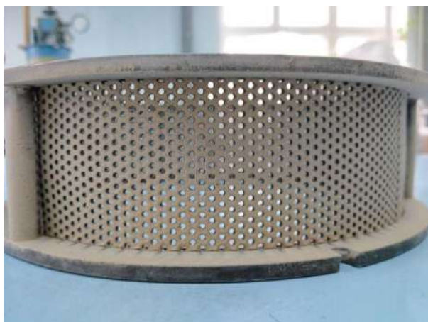
Рис. 1. Сито с диаметром отверстий 2 мм
