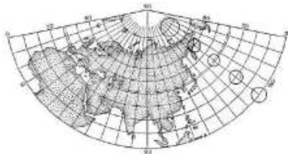
Рис. 17. Коническая равноугольная проекция.
