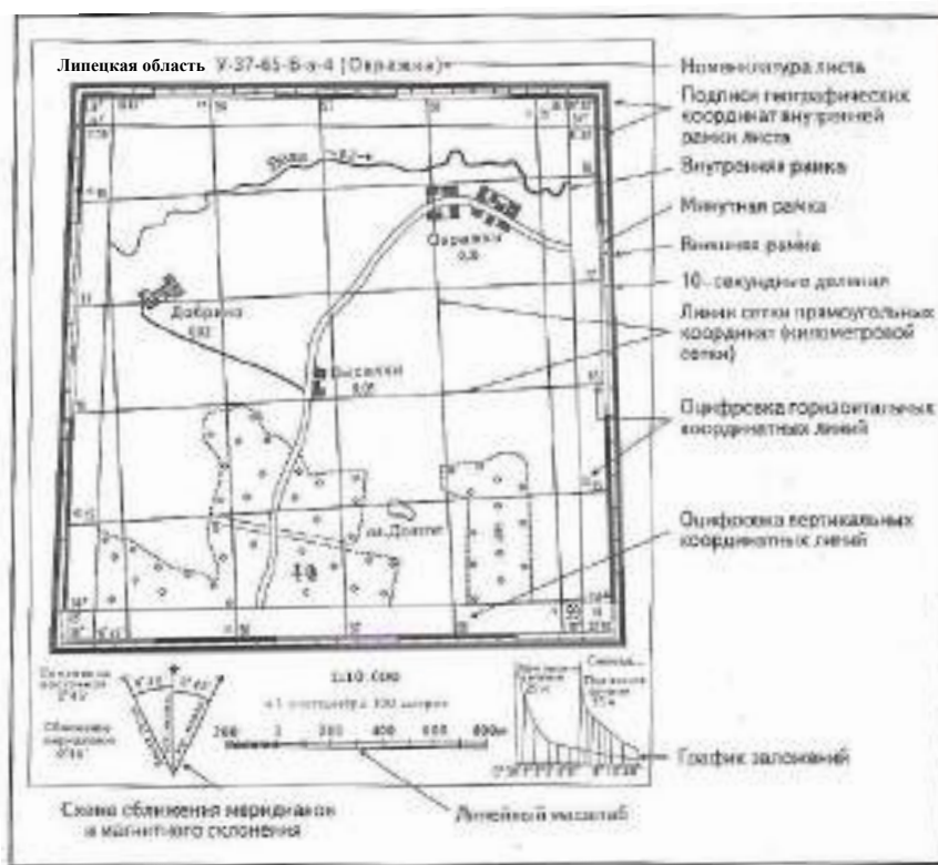
Рис. 29. Схема компоновки листа топографической карты.
