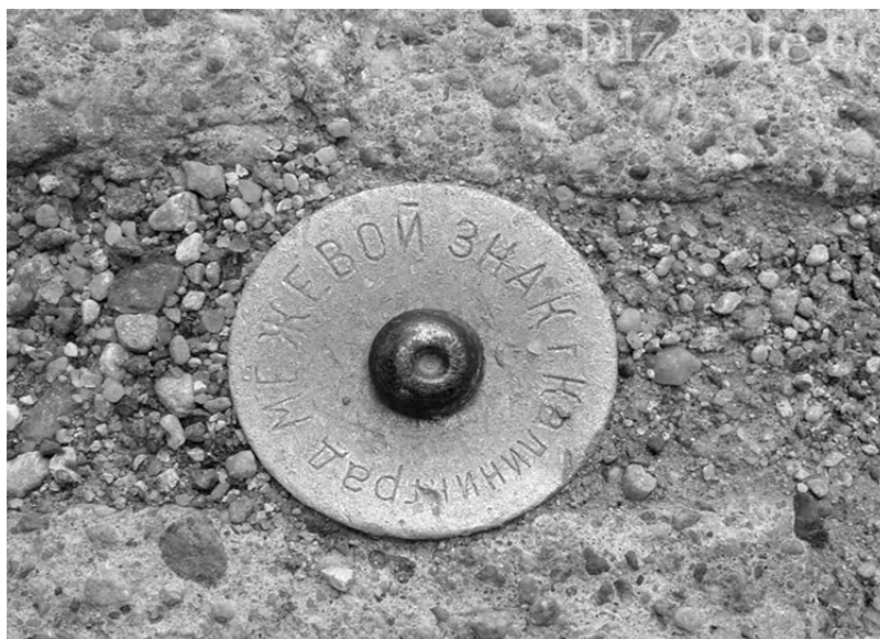
Рис.15. Внешний вид центра пункта опорной межевой сети
