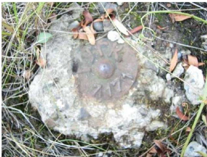
Рис. 9. Вид центра пункта ГГС
