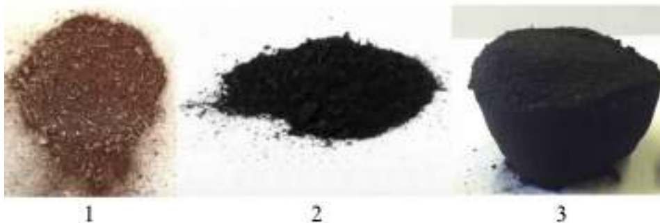
Рис. 1 – Гидролизный лигнин (1), уголь-сырец из него (2) и гранулированный уголь-сырец из модифицированного гидролизного лигнина (3)
