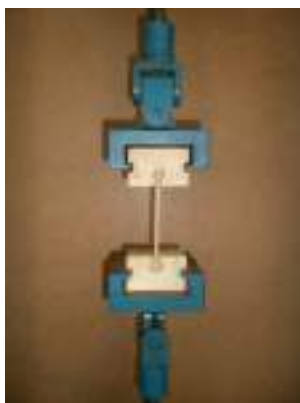
Рис. 3 – Позиционирование образца в зажимах испытательной машины
