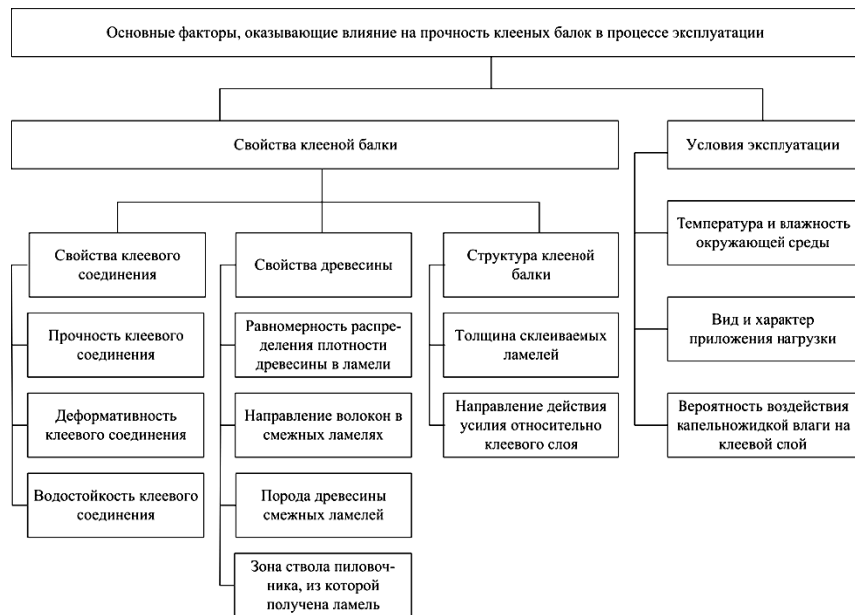
Рис. 1. Факторы, влияющие на прочность клееных балок в процессе эксплуатации Fig. 1. Factors affecting the strength of glued beams during operation
