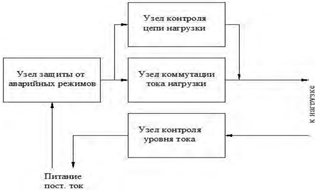
Рис. 1. Функциональная структура модуля контроля исполнительного механизма
