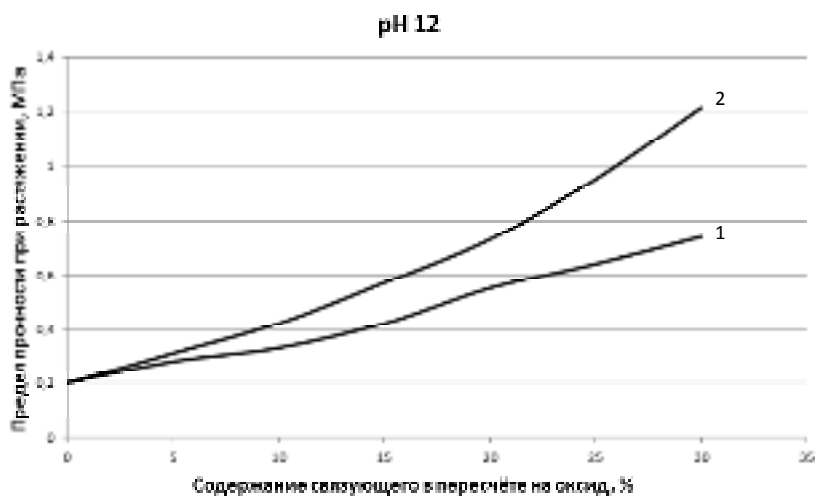
Рис. 3. Зависимость предела прочности при растяжении при pH 12 от содержания связующего с полиядерными комплексами Al (1) и Ti (2)
