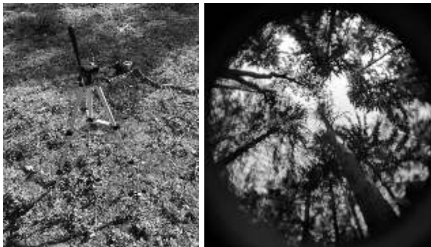
Рис. 2. Оборудование для цифровой полусферической съемки полога древостоев снизу вверх (слева) и пример снимка полога древостоя на пробной площади № 202 (справа).
