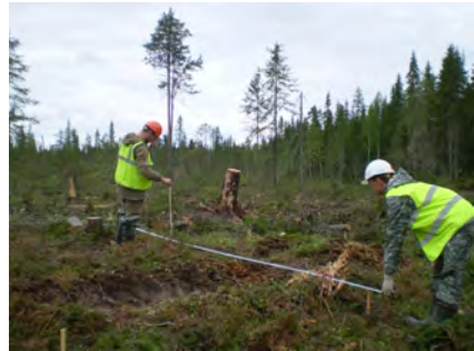
Рис. 2. Замеры колеи на пробном участке с 4 проходами техники
