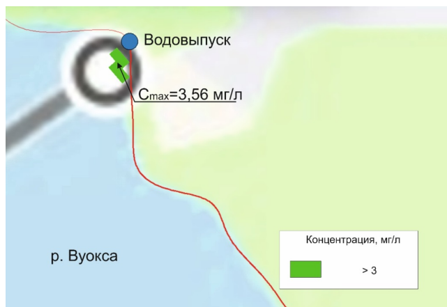
Рис. 4. Результат моделирования переноса БПК п в акватории р. Вуокса на основе решения плоской задачи
