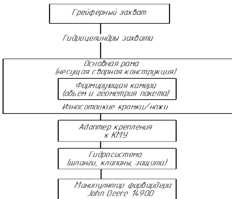
Рис. 1. Конструктивная схема подборщика лесосечных отходов John Deere 1490D
