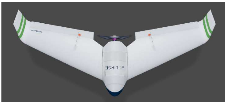
Рис. 2. Eclipse – полностью автономный беспилотник – фиксированное крыло
