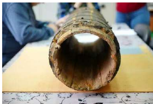
Рис. 5. Соединения клепок деревянных труб
