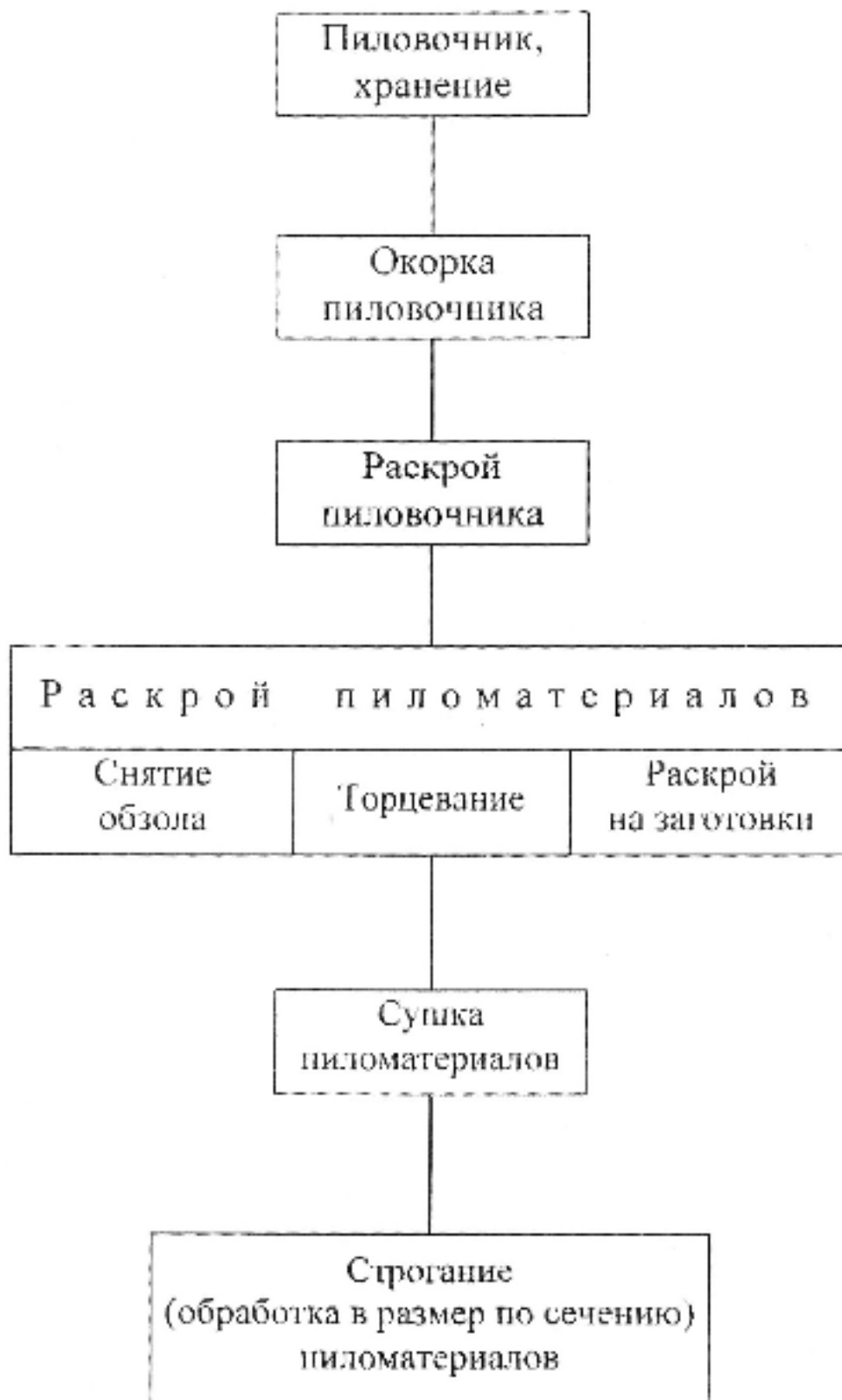
Р и с. 1 Структура технологического процесса производства пиломатериалов
