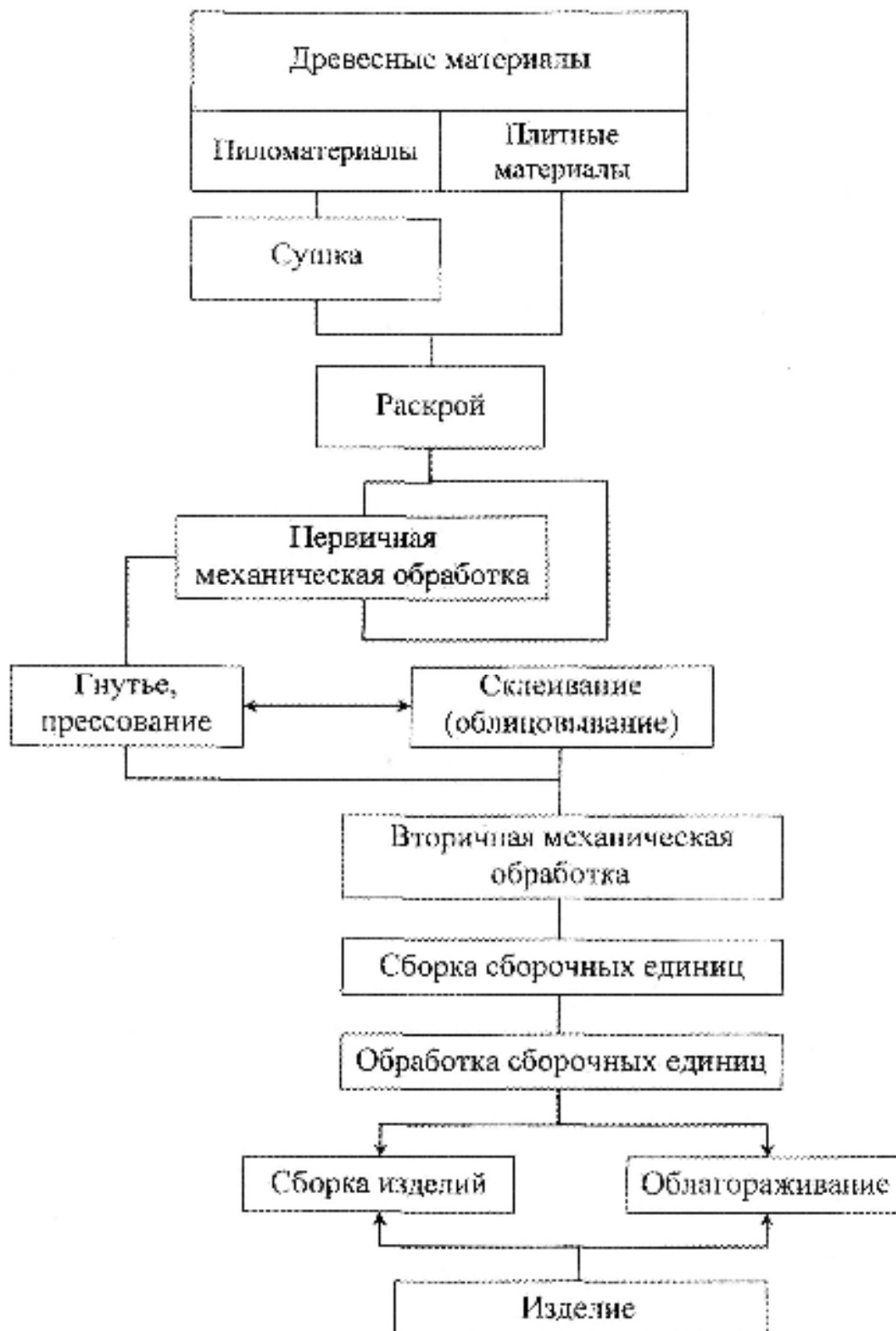
Р и с. 3 Стадийная структура технологического процесса производства изделий из древесины (мебели, оконных и дверных блоков, строительных конструкций и т.п.)
