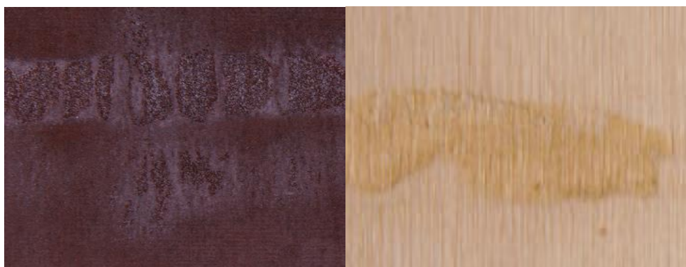
Рис. 7. Клей, просочившийся на лицевую поверхность шпона при толщине S=0,6 мм
